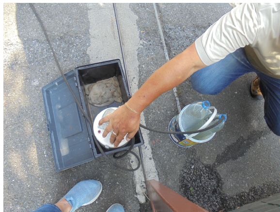
ภาพที่ 5 เก็บตัวอย่างที่บ่อตรวจคุณภาพน้ำทีก่อนระบายออกสู่ท่อระบายน้ำสาธารณะ
